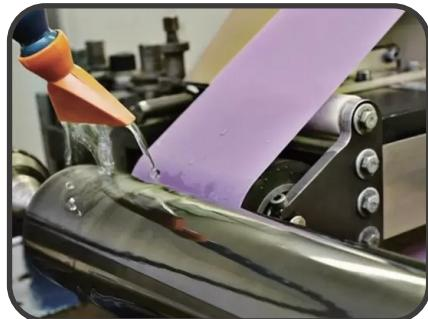
Moresuperhard ofrece películas de pulido de diamante de grano grueso a fino para el proceso de pulido de recubrimiento por pulverización térmica y un acabado de alta calidad para un rendimiento optimizado de la red de fibra óptica.
